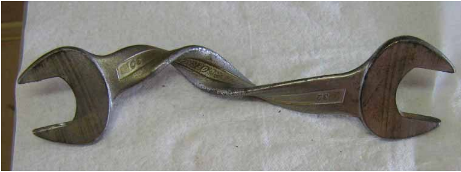
32er Schlüssel nach missglückter Pumpenpassage
